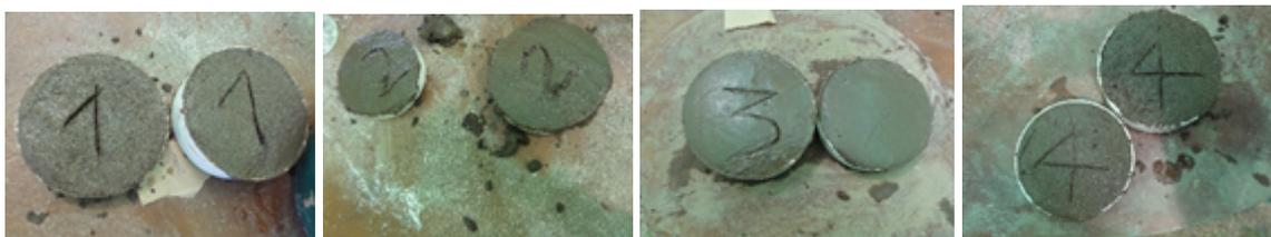
De las 4 **mezclas**, la **mejor** para revocar tiene que retraerse y fisurarse poco y ser **resistente**. El equipo ha podido notar que la mezcla 1 tenía un buen aspecto y fisuras pequeñas. La 2, con más arcilla, se había retraído y fisurado. La 3 tenía un buen aspecto y la 4 era poco resistente, rompiéndose fácilmente.
